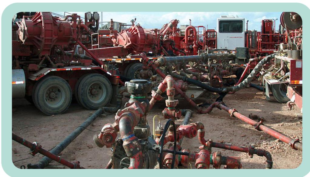
**Fotografía 14~ ~ El fracturamiento hidráulico genera ruidos fuertes, día y noche<sup>25</sup>.** Camiones con bombas grandes como estas se usan para inyectar el líquido de *fracking* en el pozo. Estas bombas son muy ruidosas. Para fracturar un pozo, trabajan juntos y al mismo momento decenas de camiones.
