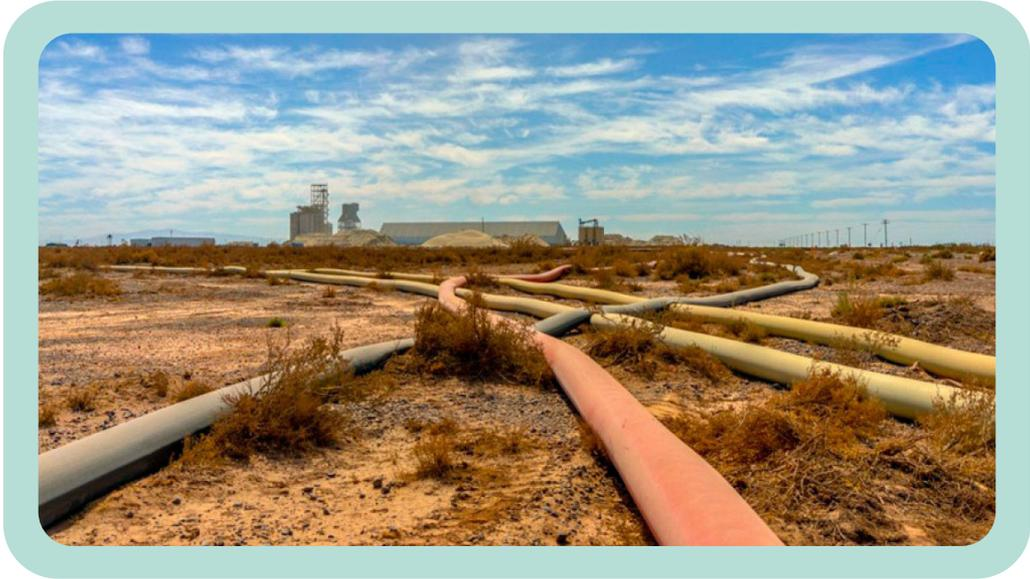
**Fotografía 13~** Mangueras que transportan agua para el *fracking*, en Vaca Muerta, Argentina<sup>24</sup>. Popularmente, se les conoce como “anacondas”.
