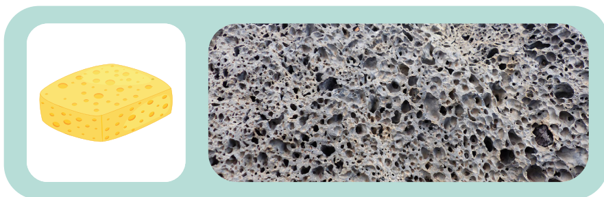
Ilustración 5~ Los yacimientos convencionales constan de rocas con poros grandes e interconectados. Son como una esponja que con facilidad suelta el agua que contiene. En un yacimiento convencional, por los poros grandes, el petróleo o gas fluye con gran facilidad hacia el pozo. (Imagen: Wikipedia)
