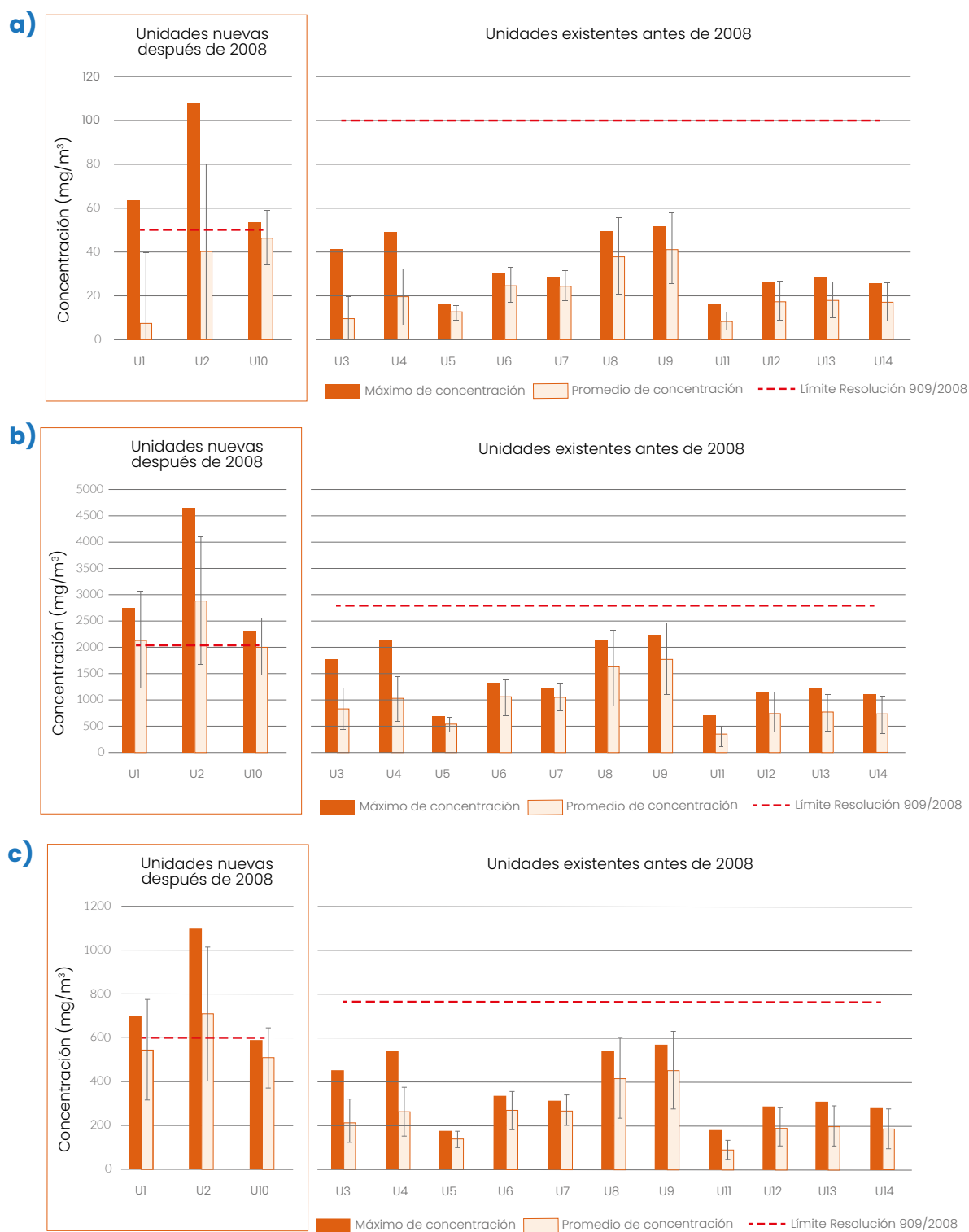
Figura 2. Concentraciones de emisiones modeladas para termoeléctricas a carbón en 2022: a) MP, b) SO 2 y c) NO x . Nota. El intervalo, representado por las barras negras, indica la desviación estándar de los datos modelados. Fuente: elaboración propia.
